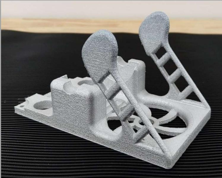
*« Cette technologie présente de nombreux avantages : le jet de gouttelettes fondues est très rapide et, avec un simple traitement thermique standard, les propriétés mécaniques dépassent les exigences. »*
